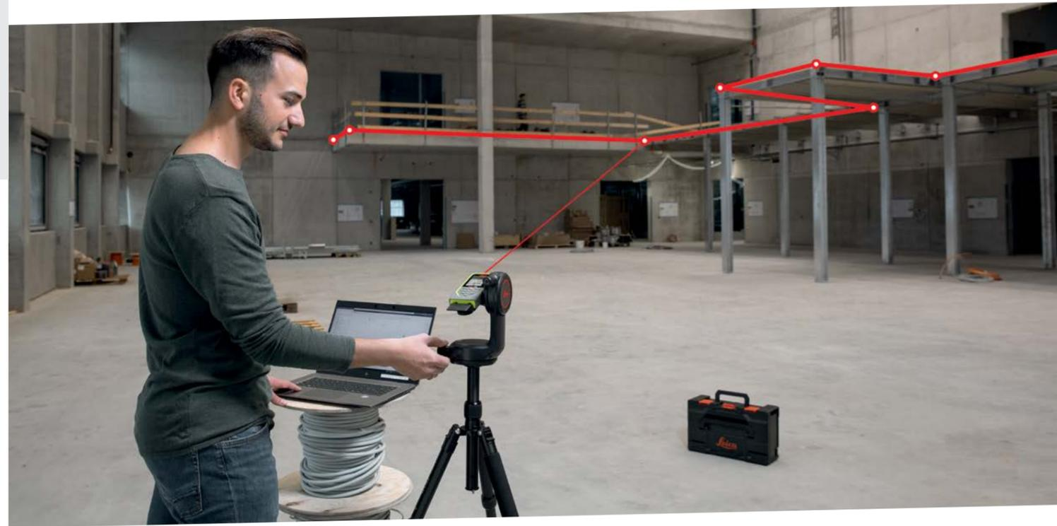
La tecnología P2P es un método de medición seguro, preciso y eficiente en cuanto a las mediciones de distancias en áreas inaccesibles o para escenarios de medición complejos. También permite un flujo de trabajo completamente digital, ya que los resultados de medición capturados se pueden procesar posteriormente en cualquier software CAD.
