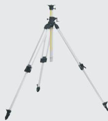
Trípode elevador de aluminio multifuncional con tornillo de fijación de 5/8", correa para el hombro, pinzas rápidas y nivel de burbuja, altura de trabajo 0,84 m - 2,46 m, con escala milimétrica, patas de goma intercambiables. N.º de art. 768 033
